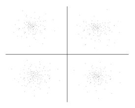
Figure 5.11. Gaussian noise (QPSK)
