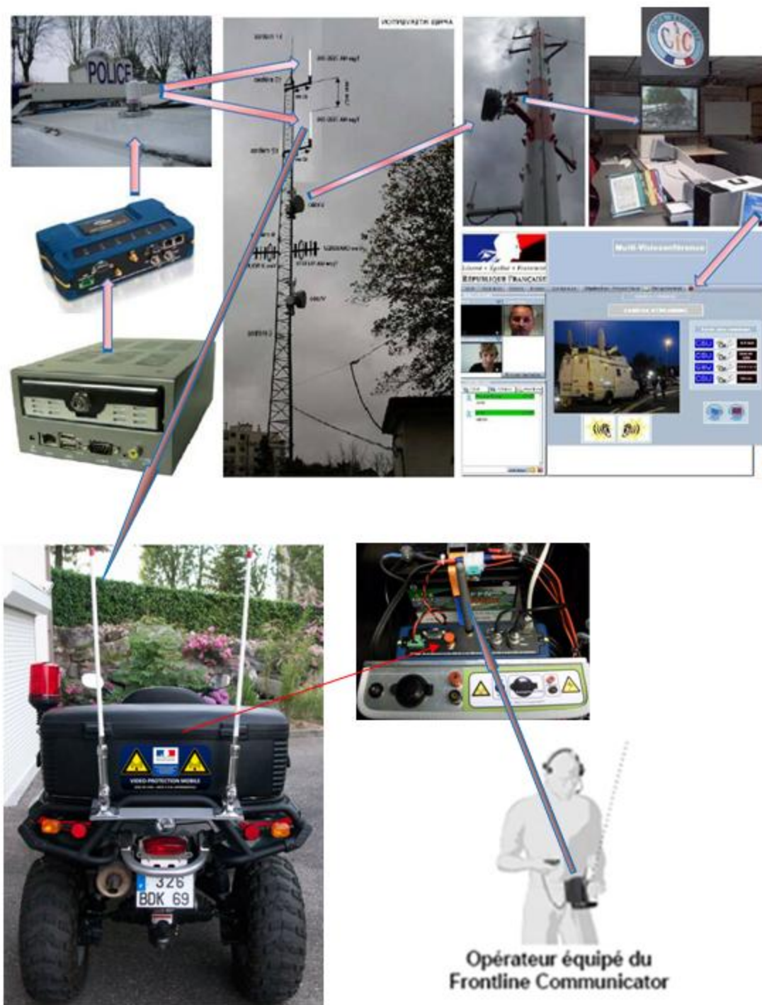
Schéma des démonstrations ; le piéton et passager équipé Vidéo et audio Frontline est relayé via le QUAD par un accès wifi intégré au MERCURY 900 opérationnel dans un rayon de 70 a 100 mètres autour du Quad
