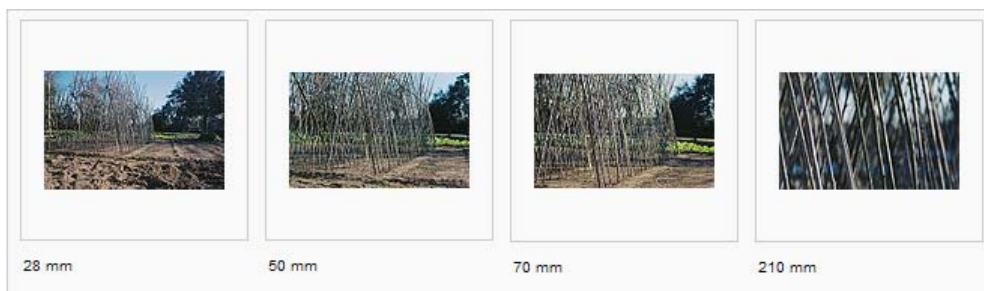
Figure 17 - Un même objet photographié à travers diverses focales depuis un même point (le photographe ne se déplace pas)
